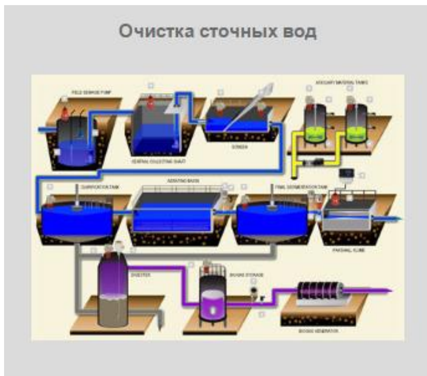
Рисунок 1 – Общий процесс очистки сточных вод
