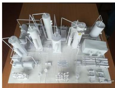
Рисунок 2 - Бумажная модель КК на основе функциональной схемы с обвязкой приборов
