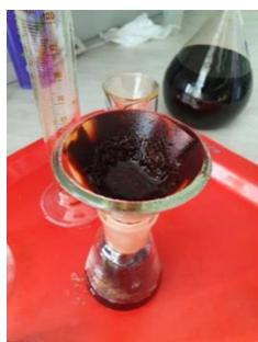
Фото 5. Удаление частиц адсорбента из раствора йода с помощью фильтрования.
