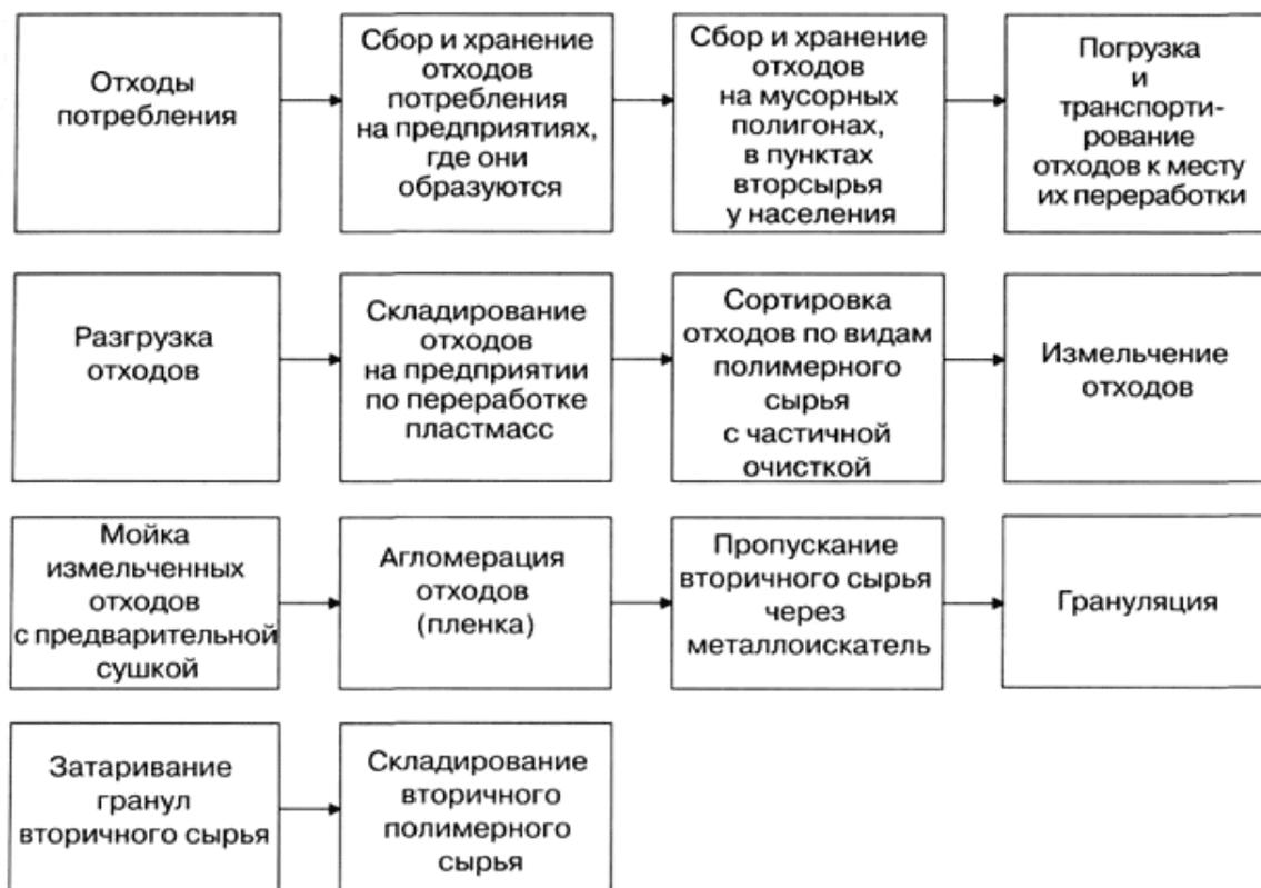
Рис унок 1 - Схема технологического процесса переработки отходов полиэтилена
