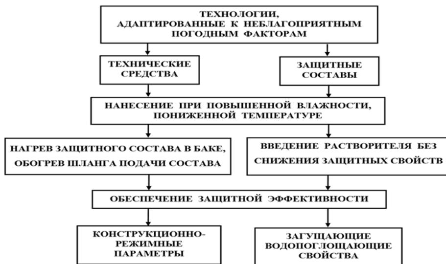
Рисунок 1 – Схема мероприятий ресурсосберегающей технологии при консервации техники
