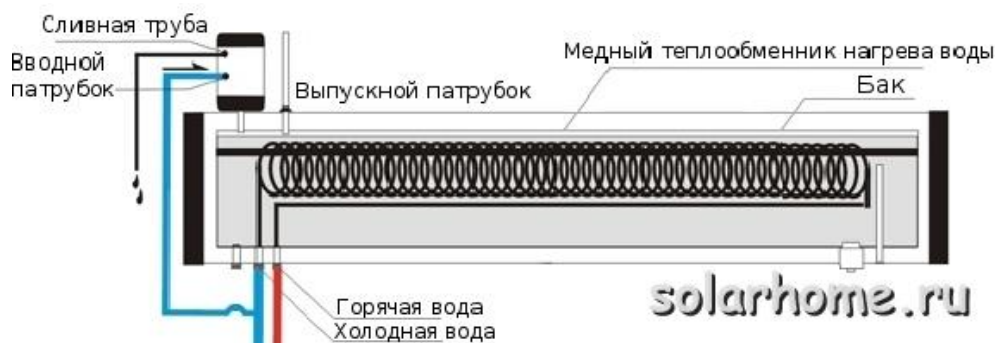
Рисунок 2 – Конструкция вакуумного коллектора с тепловыми трубками KD-PH-HP
