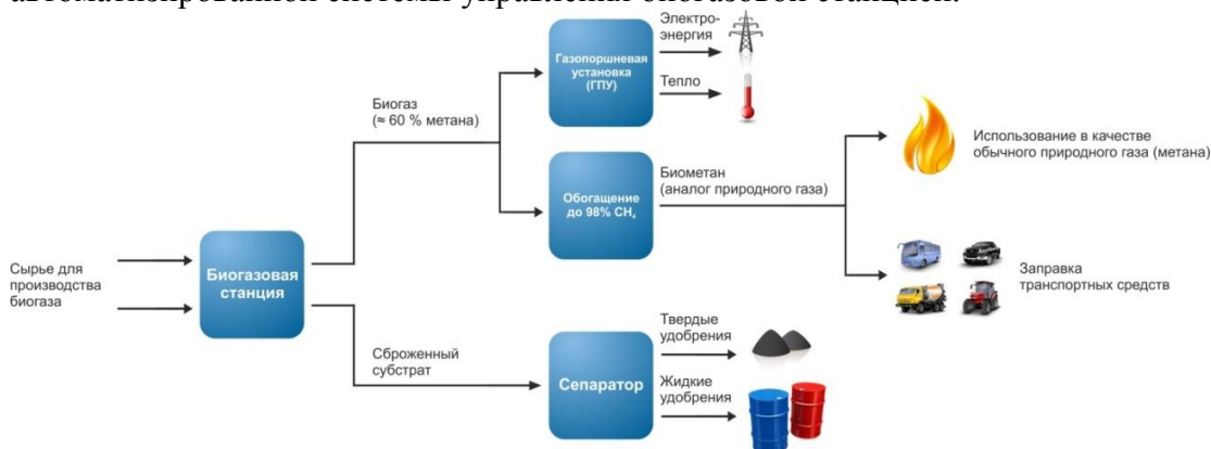
Рисунок 1 – Принцип работы биогазовой станции
