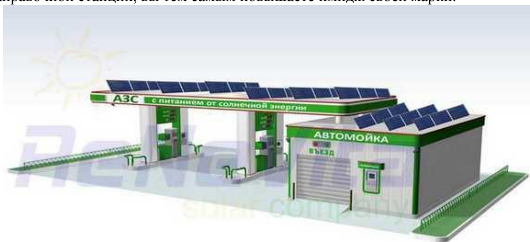
Рисунок 1 – Макет АЗС с фотоэлектрическими панелями на крыше
