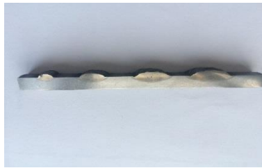
Рис. 5. Газовые поры, выявленные на макрошлифе сварного шва
