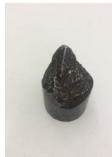
Рис. 3. Излом цапфы выгрузного шнека зерноуборочного комбайна
