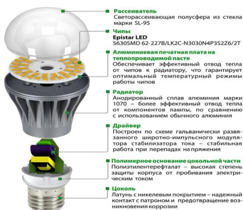
Рисунок 5 – Строение светодиодной лампы
