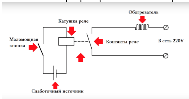
Рисунок 1 – Схема включения реле
