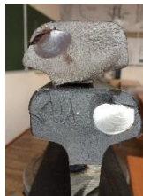
Рис. 4. Излом рельса, вызванный наличием флокена
