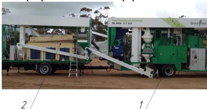
Рисунок 3 - Составной зерно-семяочистительный агрегат фирмы «Brucefield Seed Cleaning» (Австралия)
