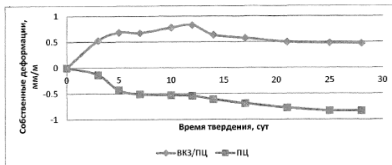
Рисунок 1 - Собственные деформации золо-цементного и цементного камней во времени
