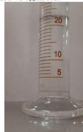
Для определения прозрачности воды был использован метод Снеллена: взяли прозрачный мерный цилиндр с плоским дном, в который налили воду. Подложили под цилиндр расстояние 4см от дна шрифт, высота букв которого 2мм, а толщина линии букв 0,5мм и сливали воду до тех пор, пока сверху через слой воды не стал виден этот шрифт. Измерив высоту столба оставшейся воды линейкой, выразили степени прозрачности в см. Чем больше высота столба, тем выше степень прозрачности (35 см.).
